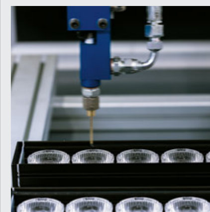
Silikonisierung des Diffusors Силиконовое покрытие рассеивателя
