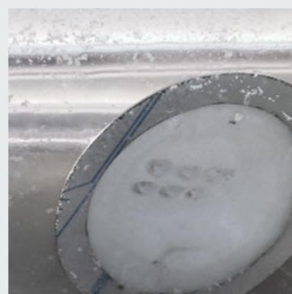
Beständigkeitstest gegen niedrige Temperaturen -30° Испытание на устойчивость к низким температурам -30°
