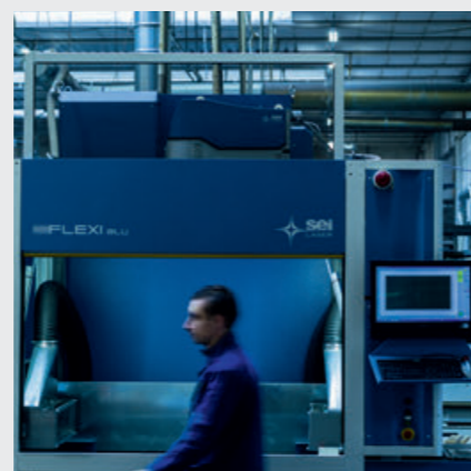
машина для нанесения микронесечек с помощью лазера на ПММА.
