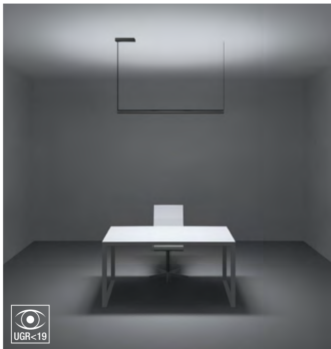
Sala 5x5 m/Altura sala 3 m/Escritorio 1600x800 mm Altura de montaje de la lámpara de pie 2 m/Modelo 76385W61
