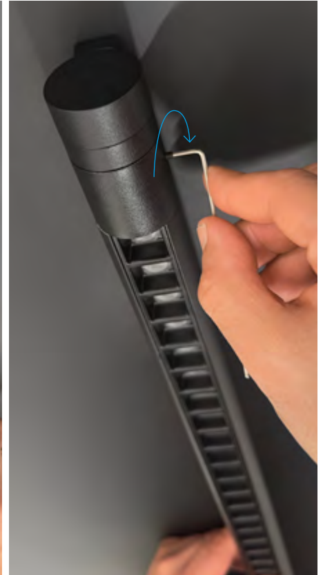
Apriete del tornillo de seguridad
