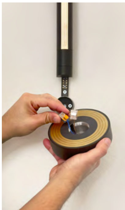
Conectar los cables de alimentación (para la gestión DALI, conectar también los cables de señal).
