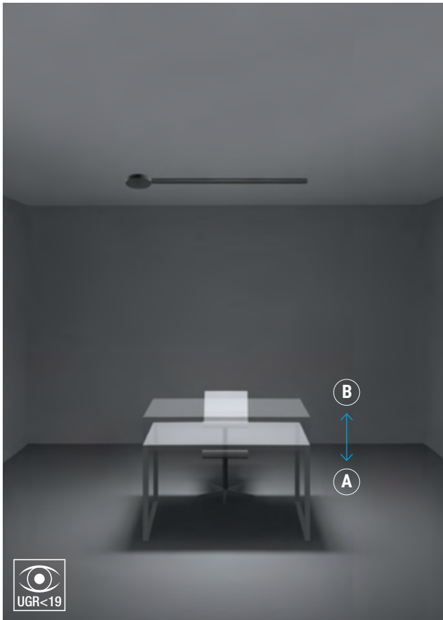
Raum 4x4 m / Raumhöhe 2,8 m / Verstellbarer Schreibtisch 1000x600 mm / Montagehöhe der Lampe vom Boden 2,8 m / Modul mit Einzelemission L.1188 mm - 24 W DC - 3000 K - CRI90 (76381W50)
