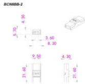
Connettore - Connettore rapido per Ribbon Basic V2 8mm, Ribbon HD 8mm (no Ribbon COB)
