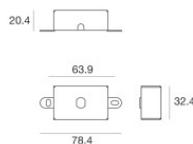
Base per fissaggio - Basetta senza alimentatore
