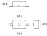
Base per fissaggio - Basetta senza alimentatore
