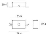
Base per fissaggio - Basetta senza alimentatore
