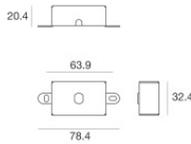
Base per fissaggio - Basetta senza alimentatore
