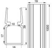
Controcassa - Profilo lineare con passaggio cavo in alluminio 39x18x1000mm per Rubber 3D, Rubber 3D Concrete, Rubber 3D 48V, Rubber 3D Optic, Rubber 3D Pixel
