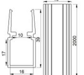
Controcassa - Profilo lineare con passaggio cavo in alluminio 39x18x2000mm per Rubber 3D, Rubber 3D Concrete, Rubber 3D 48V, Rubber 3D Optic, Rubber 3D Pixel
