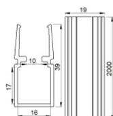
Controcassa - Profilo lineare con passaggio cavo in alluminio 39x18x2000mm per Rubber 3D, Rubber 3D Concrete, Rubber 3D 48V, Rubber 3D Optic, Rubber 3D Pixel
