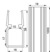
Controcassa - Profilo lineare con passaggio cavo in alluminio 39x18x1000mm per Rubber 3D, Rubber 3D Concrete, Rubber 3D 48V, Rubber 3D Optic, Rubber 3D Pixel
