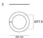
Fissaggio per controsoffitto - Anello per installazione su cartongesso
